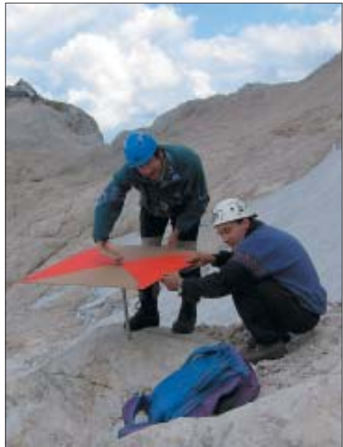
Utrinki z merjenja Triglavskega ledenika leta 2005: ostanki ledenika (levo zgoraj), Matija Zorn in Miha Pavšek nameščata merilne točke »dežnike« (desno zgoraj), Matija Zorn in Blaž Barborič z geodetskimi merilnimi napravami (levo spodaj), Mauro Hrvatin in Primož Pipan postavljata merilno točko (desno spodaj).
