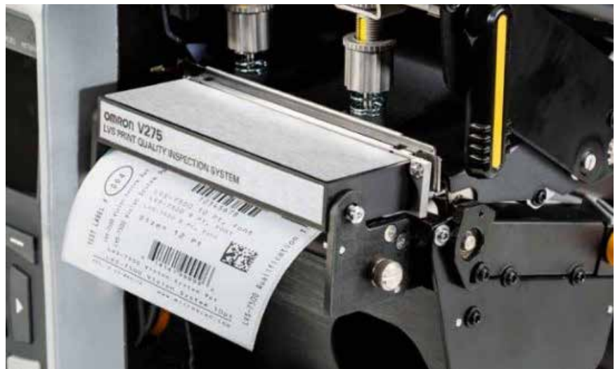
Slika 1: Tiskalnik etiket z vključeno verifikacijo etiket
