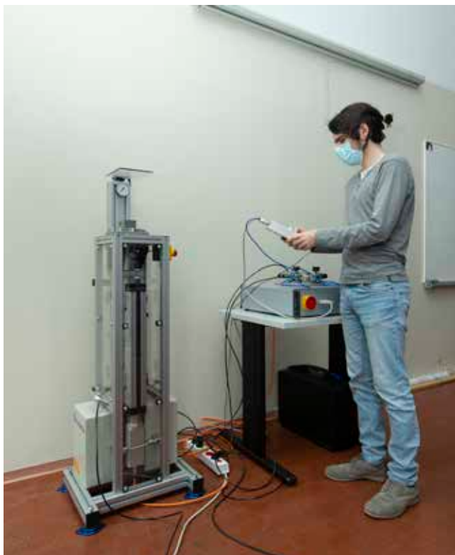
Slika 6 : Pulzni dinamični generator tlaka kapljevine (Foto: IFP, d. o. o.)
