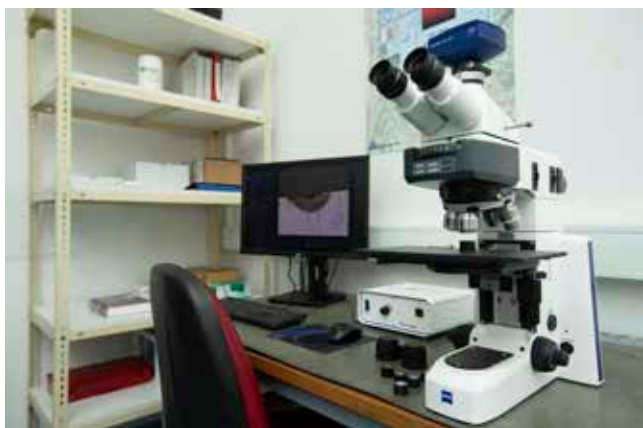
Slika 5 : Metalurški optični mikroskop ZEISS AxioScope 5 z dodatki (Foto: IFP, d.o.o.)
