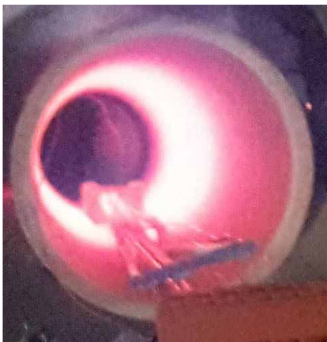
LTCC piezorezistivni tlačni senzor med testiranjem pri temperaturi okoli 600 °C
