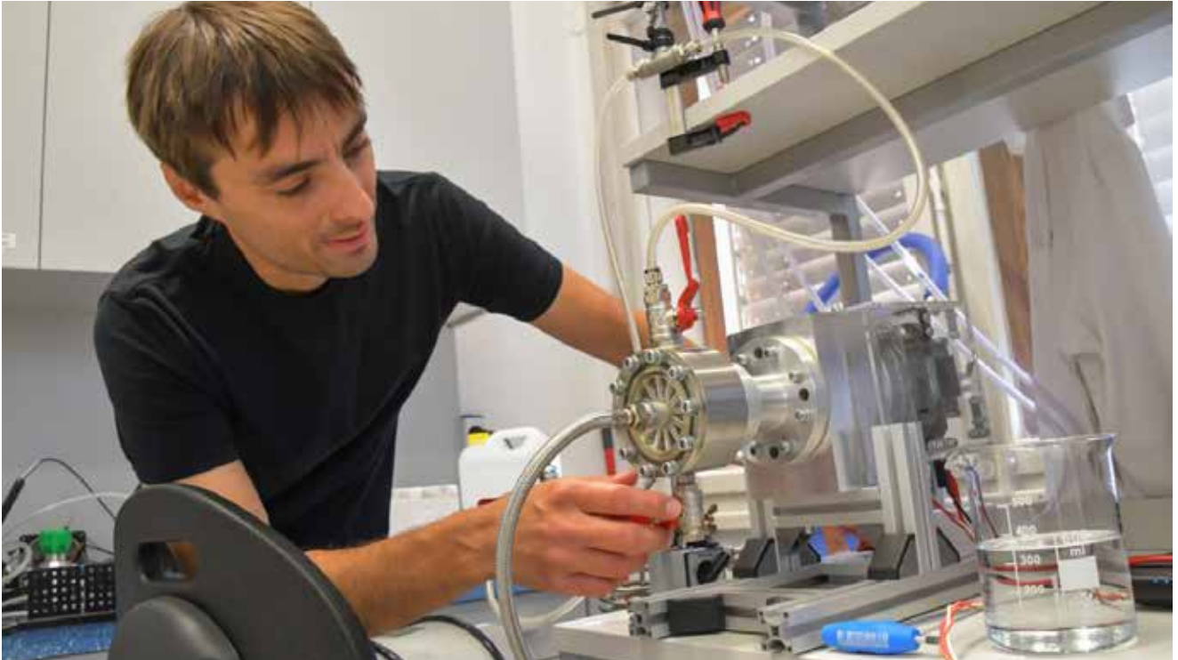
Laboratorijska izvedba rotacijskega generatorja hidrodinamske kavitacije na katerem izvedemo prve korake od bazičnih raziskav k aplikaciji
