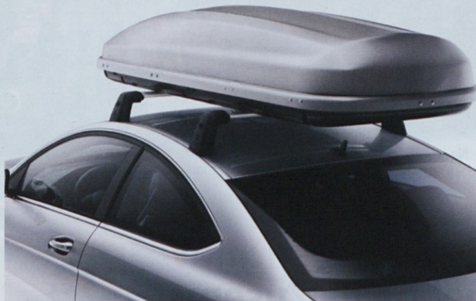
Dodatna oprema lahko poveča zračni upor in posledično tudi porabo goriva.
