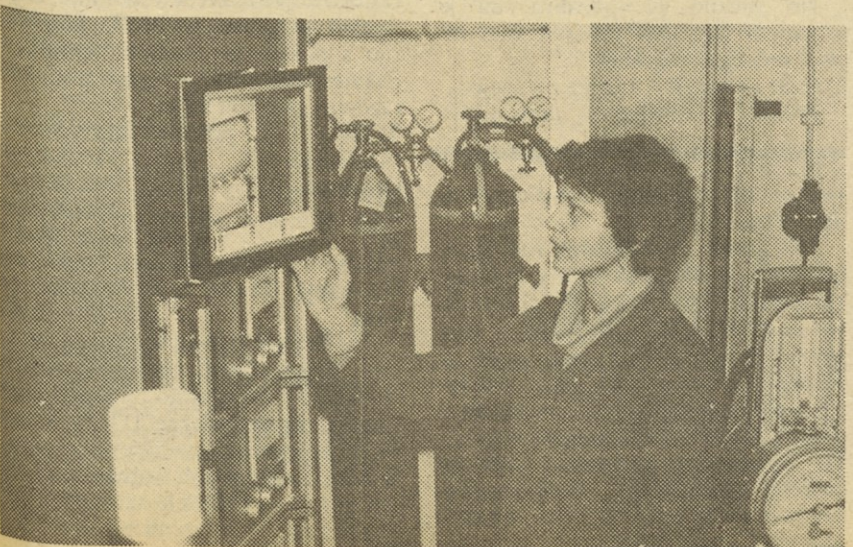
Laborantka Marica Mesec meri izgorevanje plinske peči.
