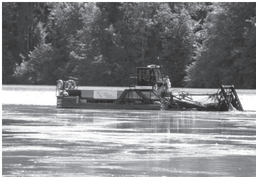
Slika 6: Plovilo s podvodno kosilnico, ki se uporablja za podvodno košnjo problematične vodne zarasti (pretežno vrste E. canadensis ) na Zbiljskem jezeru. (Vir: Delo)
