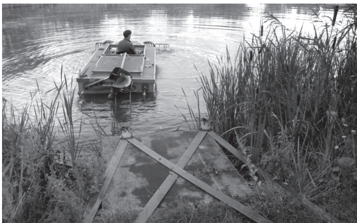
Slika 7: Pridrno V-rezilo, ki se uporablja za obvladovanje problematične vodne zarasti. (Vir: https://www.aquacontractor.co.uk/ )
