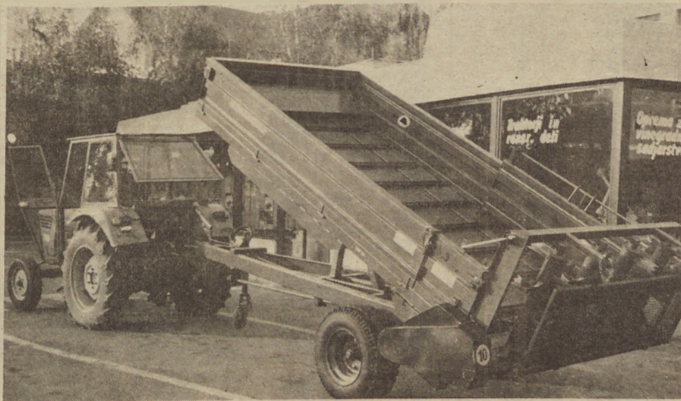
UNIVERZALNI STROJ ZA TROSENJE GNOJA IN PREVOZ KMETIJSKIH PRIDELKOV IN SILAŽE — TG 4VK
