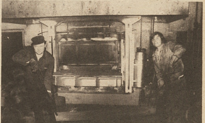
Delo vlagavev je izredno težko, še huje pa je pri vročem vlečenju. Takrat morajo iz peči s posebnimi kleščami potegniti razbeljeno železo – od 850–950° C, ga odnesti do stiskalnice, položiti na pravo mesto, po stiskanju pa spet dvigniti in odnesti stran. Na sliki sta vlagavev velikanke Jože in Zdravko.
