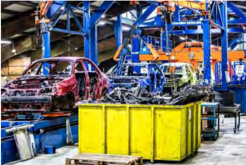
Slika 2: Linija za razstavljanje vozil
