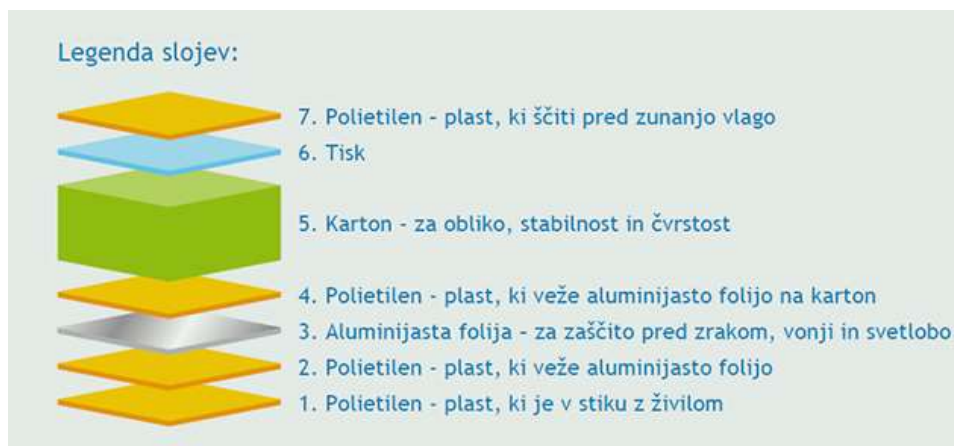
Slika 3: Sestava embalaže tetrapak ( http://www.eko-paket.si/ )
