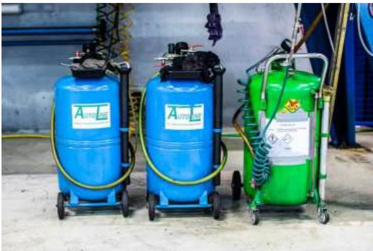
Slika 4: Posode za odstranitev tekočin
