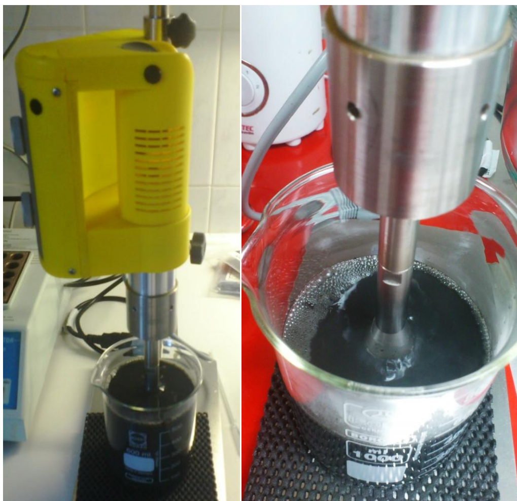
Slika 17: Homogeniziranje blata iz čistilne naprave z ultrazvočnim homogenizatorjem UP200H proizvajalca Hielscher.
