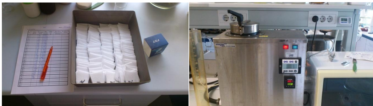
Slika 34: Ankom vrečke (levo) in Ankom Fiber Analyzer za določevanje vsebnosti lignina, celuloze in hemiceluloze (desno).
