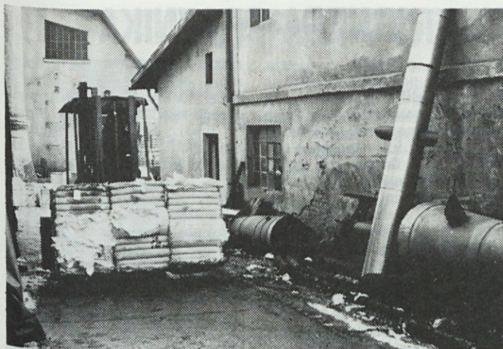
V januarju smo kupili nov viličar nosilnosti 1.500 kg. Hidravlične klešče so nam izdelali v Gradmetalu. Na fotografiji vidimo, da je novi viličar že dobro izkoriščen.
