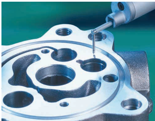
» Slika 2: Merjenje hrapavosti z napravo SV-3200
