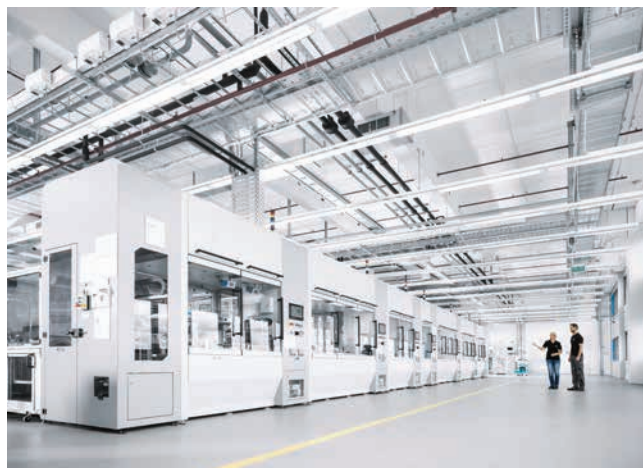
» Popolnoma avtomatizirana in modularno zgrajena montažna linija z osmimi proizvodnimi celicami meri v dolžino približno 30 metrov, na leto pa izdelava in sestavi več kot en milijon ventilov VUVG. (foto: Festo AG & Co. KG)
