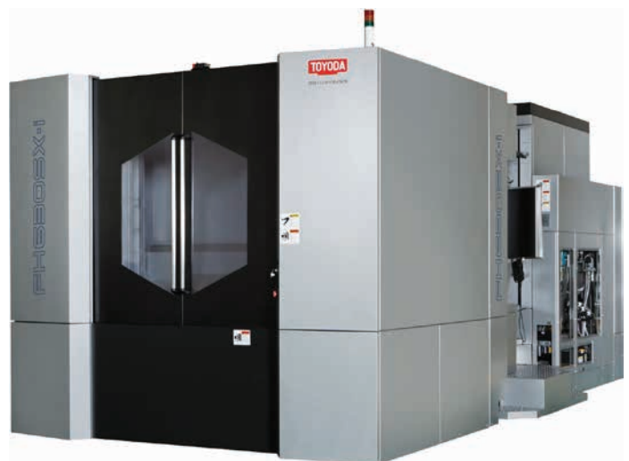
» Slika 1: CNC horizontalni obdelovalni center Toyoda FH 630 SXi s temperaturno kompenzacijo v realnem času.
