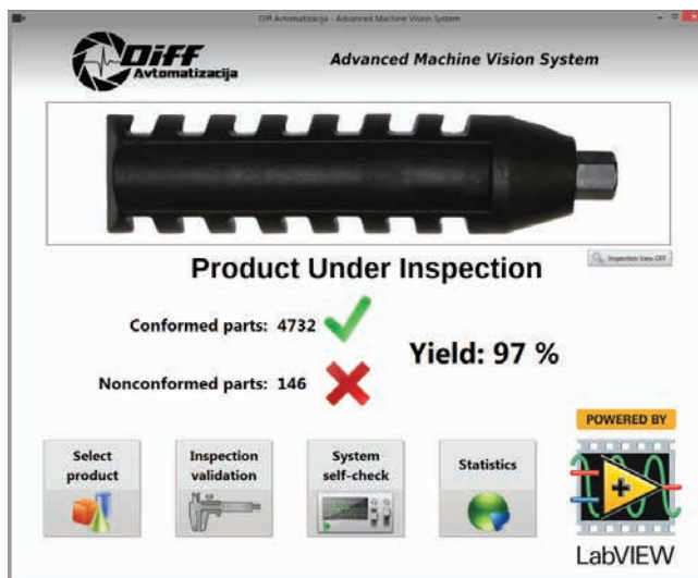
» Slika 2: Zaslon na dotik in uporabniški vmesnik po meri v okolju LabVIEW
