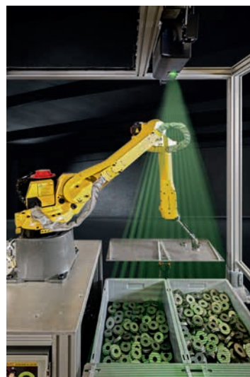
» Fanucov 3D-senzor območja je na nosilcu nad zabojem in usmerja robota, kateri del naj izbere.
