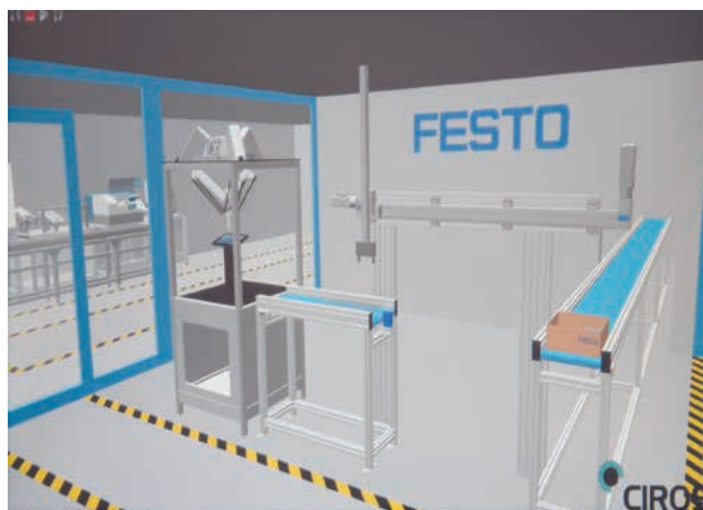
» S simulacijskim orodjem CIROS od Festo Didactic lahko uporabnik zgradi digitalni model želenega sistema in s tako imenovanim navideznim zagonom (angl. virtual commissioning ) preveri njegovo delovanje. Z dodatnimi vmesniki OPC-UA za Industrijo 4.0 ali internet stvari IoT ter s pretvornikom modela in nastavitvev CODESYS V3 je razvoj projekta s sestavinami CPX in EMCA pripravljen za Industrijo 4.0. (Foto: Festo AG & Co. KG)
