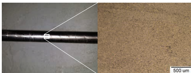
» Slika 2: Eksperimentalno kontinuirno odlita palica iz zlitine niklja in titana z značilno mikrostrukturo
