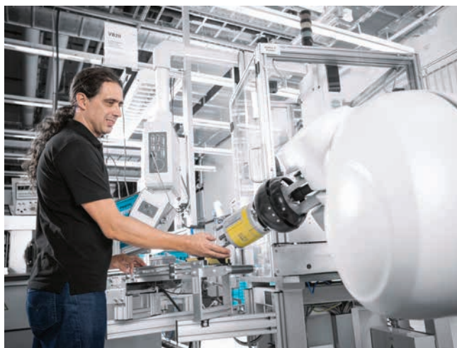
» Prilagodljivi in sodelujoči robot dela pri sestavljanju ventilov v neposredni in varni interakciji z zaposlenimi. (Foto: Festo AG & Co. KG)
