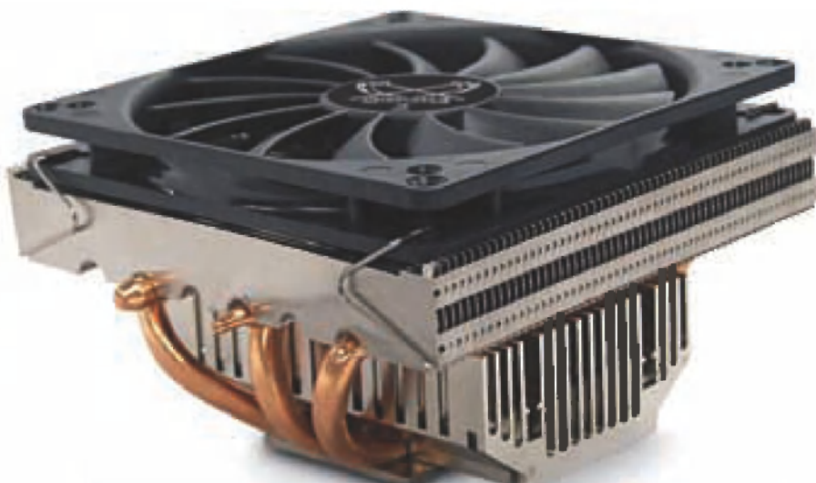
Hladilnik procesorja ima v sodobnem računalniku veliko dela. Zelo dobro se obnesejo rešitve, grajene na konceptu t. i. vročih cevi (angl. hot pipe), ki toploto od sredice procesorja hitreje prenašajo do tankih lističev hladilnika, kjer jo ohladi ventilator.
