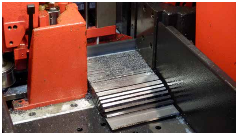
» Masovni razrez na kratko dolžino z žago PCSAW 330 je visokoponovljiv, območje rezanja pa enostavno dostopno.
