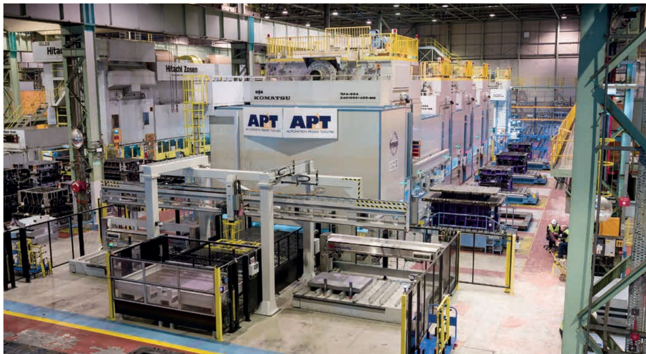
» Nissanova linija stiskalnic je po prenovi produktivnejša za 45 odstotkov. Eno obstoječo stiskalnico so odstranili, ostale pa opremili s sistemom za avtomatizacijo AP&T.
