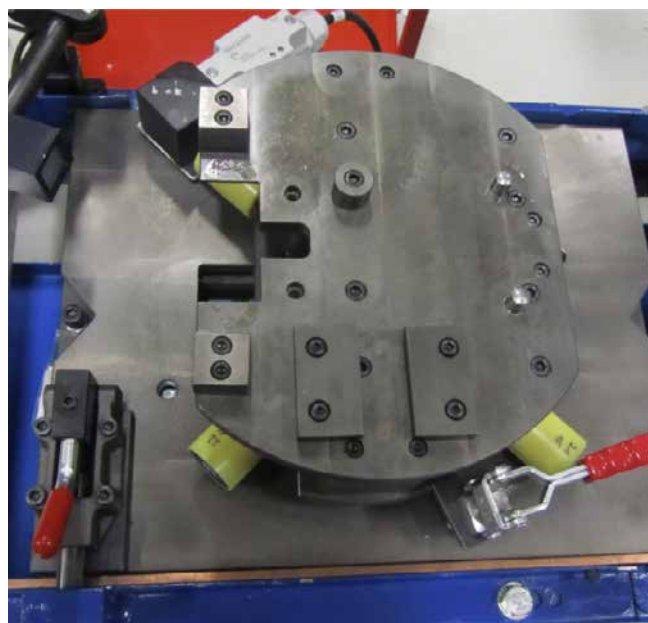
» Slika 4: Vpenjalna priprava glavnega ohišja (1-bralna glava, 2-RFID z zapisom številke palete in pozicije, 3-spona za fiksiranje na delovnem mestu, 4-spona za fiksiranje pozicije, 5-bliskavica za osvetlitev 2D kode, vgravirane na spodnji strani podsestava, branje se izvaja s čitalcem pod valjčno progo) [1]
