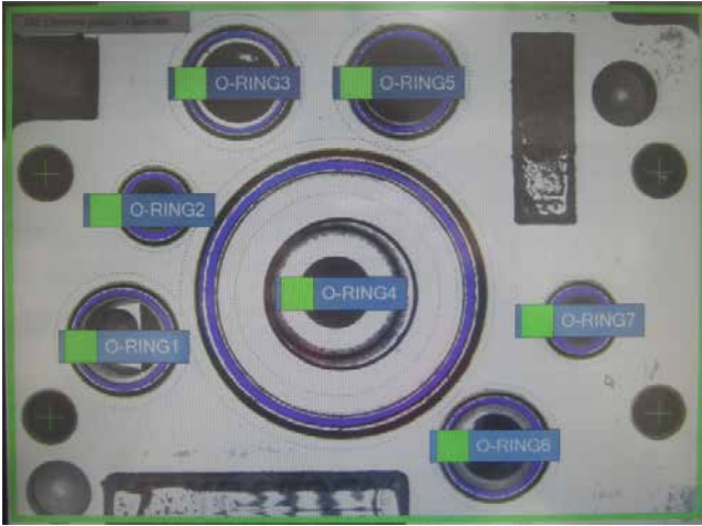
» Slika 6: Primer kontrole pravilne montaže O-ringov [3]
