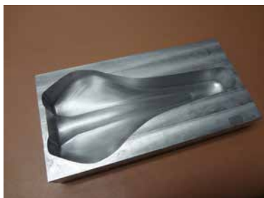
» Slika 1: Orodje za izdelavo kompozitnega izdelka. Pred laminacijo kompozita je potrebna predhodna obdelava - čiščenje in nanos ločevalca.
