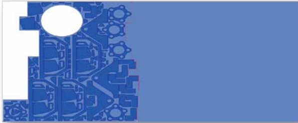
» Gnezdenje na ostankih in shranjevanje novega ostanka
