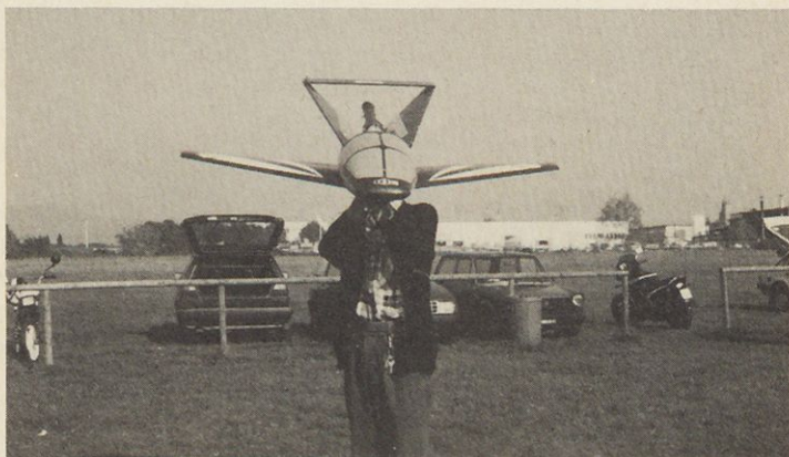
Pogled modela od spredaj. Premer krila je 1400 mm. V »V« repu je vidna izpušna cev pulzoreakcijskega motorja.
