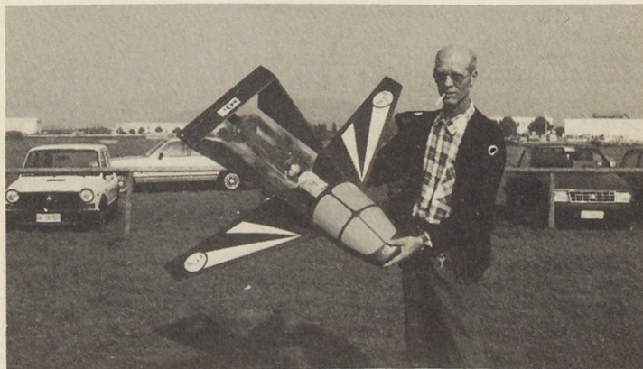
Model, na katerem je lepo viden pulzoreakcijski motor.
