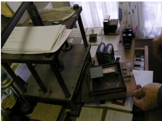
Slika 52: Prešanje bakelitne plošče v svinčene črke
