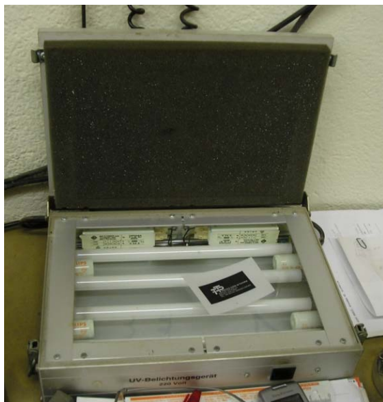
Slika 56: Osvetljevanje polimera prek pavz-papirja v napravi za osvetljevanje z UV-žarki
