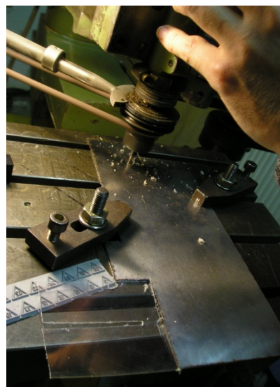
Slika 55: Izrezovanje polimernega koščka
