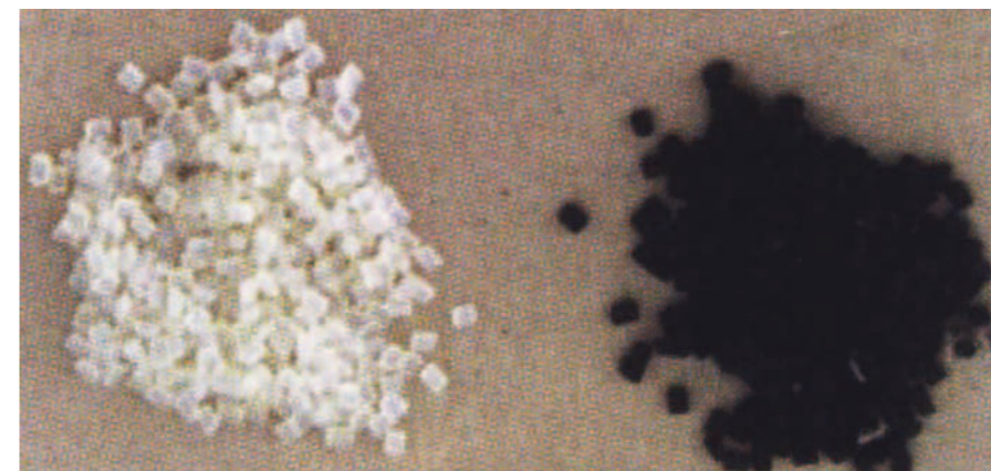
Slika 1:Plastična zrna pred in po adsorpciji ostankov tiskarske barve pri recikliranju grafičnega papirja.
