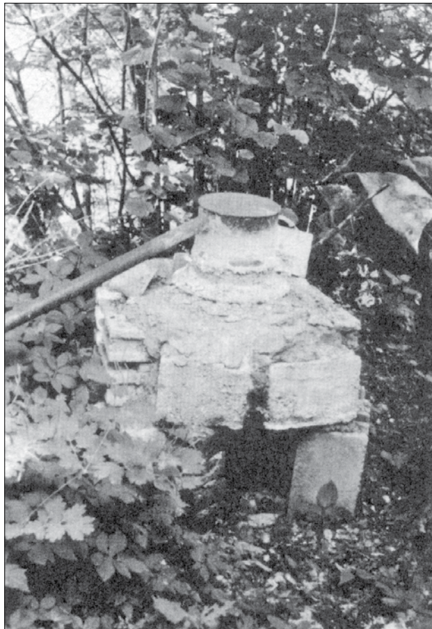
Naprava, v kateri pripravljajo črno olje ali smolenak. Fotografija je bila posneta pri Pečovniku v Robanovem kotu.
