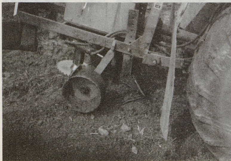
Kratek obrezovalnik za hmelj z nogičami za podrahljavanje.
