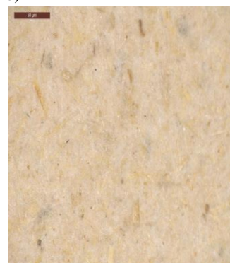
Slika 4: Papir iz japonskega dresnika a) in izgled površine posnet z OM b)
