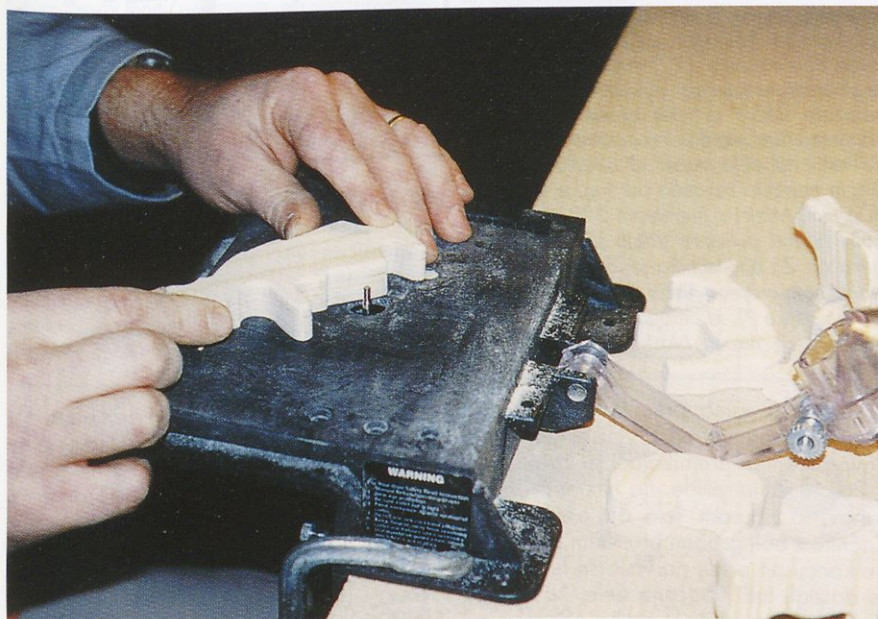
Slika 2. Rezkalna mizica + električni vrtalnik = stabilni rezkalnik
