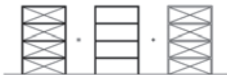
Slika 16: Pomični okvir + koncentrične diagonale (majhna podajnost). Moment resisting frame + concentric bracing (small elasticity).
