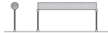
Slika 13: Konzolna konstrukcija - obrnjeno nihalo (velika podajnost). Cantilever structure - inverted pendulum (greater elasticity).
