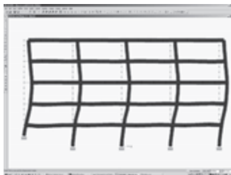
Okvirna konstrukcija s kratkim stebrom. Nihajni čas je 1,6 s. Frame structure with short column. Oscillation time is 1,6 s.
