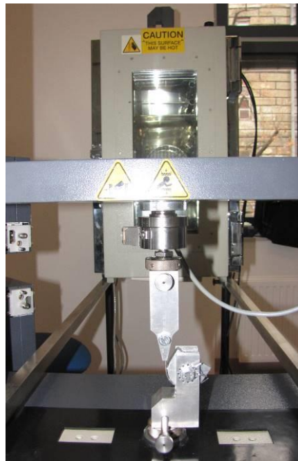
Slika 4: Orodje, vpeto v stroj za testiranje Zwick/Roell Z010
