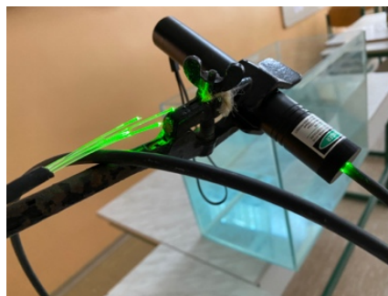
Slika 9: Popolni odboji v optičnem vodniku (poskus pri uri)
