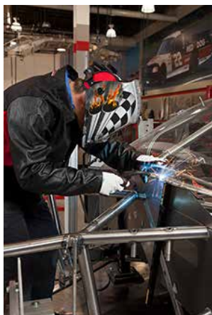
» Na izbor varilne maske in filtra za zaščito oči vplivajo: varilni postopek, material in občasna ali celodnevna uporaba.
