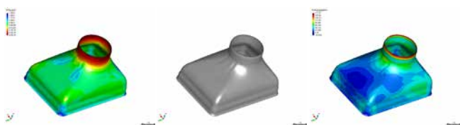
» Slika 3: Komponenta v simulacijskem sistemu Stampack med simulacijo distribucije debeline (levo). Komponenta po končanju simulacije (sredina). Stopnja izkoriščenosti meje formiranja (desno).
