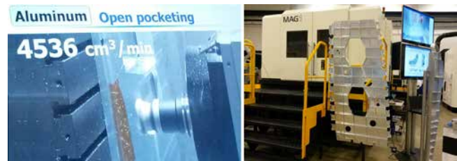
Slika 4: Levo: demonstracija obdelave z visoko stopno odvzema materiala, desno: obdelan kos velikih dimenzij na stroju Makino MAG1.
