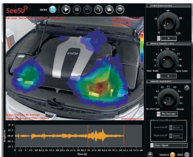
» Slika 1. Zvočna kamera SeeSV se uporablja za ugotavljanje učinka pokrova motorja na modelu Hyundai Genesis.
