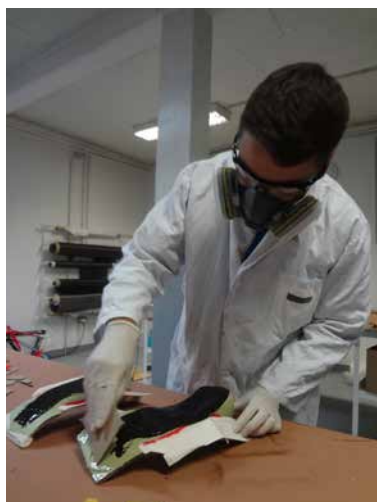
» Slika 1: Izdelava kompozitnih orodij neposredno iz modela - prototipa (primerno za prototipe in manjše serije)
