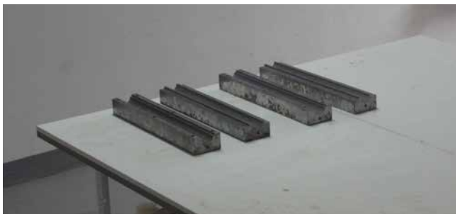
» Slika 3: Jeklena orodja za izdelavo cevi (po vsakem razkalupljanju sledi čiščenje in nanašanje ločilcev)
