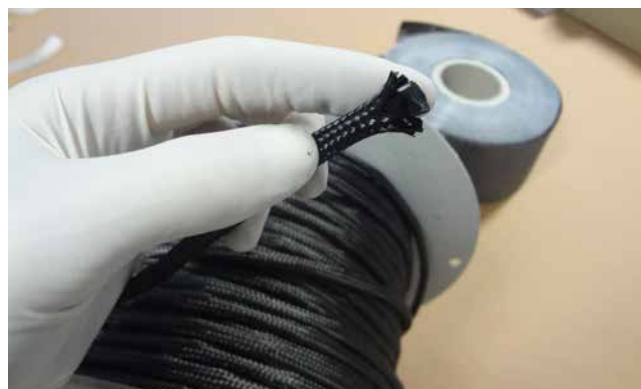
» Slika 4: Za izdelavo določenih cevi/profilov, se lahko uporablja tudi pletene cevi. Na fotografiji primer karbona, ki je pleten tako, da končni izdelek tvori polno karbonsko cevko premera 7mm, s pomočjo tehnologije RTM se vlakna prepoji s smolo, primerno za masovno proizvodnjo.
