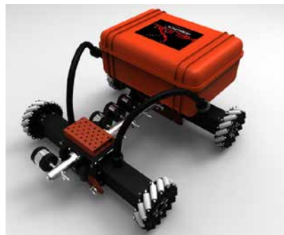
» Lahek plezalni robot za varjenje in rezanje z magnetnimi kolesi: HR-MP20T.
