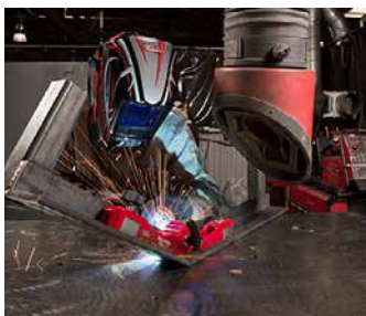
» Na izbor varilne maske in filtra za zaščito oči vplivajo: varilni postopek, material in občasna ali celodnevna uporaba.
