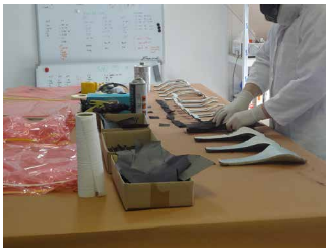
» Slika 2: Uporaba orodij iz kompozitov
