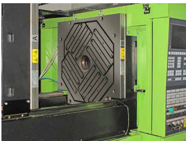
» Slika 1: Skoraj 30 strojev za brizganje plastike znamk Engel, Arburg und Krauss Maffei je opremljenih z magnetnimi vpenjalnimi ploščami M-TEC 130. Palaplast obdeluje na njih verarbeitete auf ihnen pretežno Polypropylen (PP), Polyethilen (PE) ali Polyvinylchlorid (PVC) pri temperaturah med 20 in 60 C.
