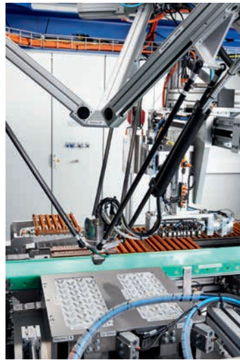
» S taktom 120 sestavnih delov na minuto dva tripodna (deltoidna) robota EXPT polnita pladenj za elektronske sestavine. (Foto: Festo AG & Co. KG)
