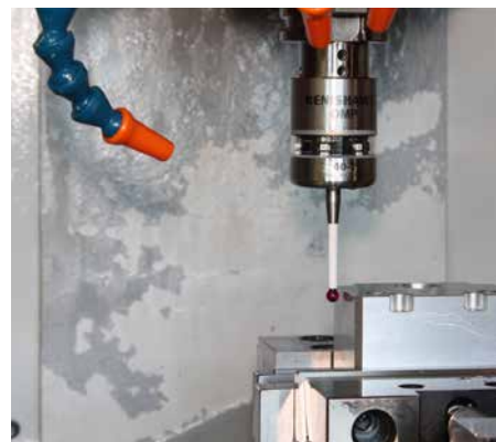
» Spoznavanje praktičnih vidikov: merilna glava Renishaw z optičnim prenosom podatkov
