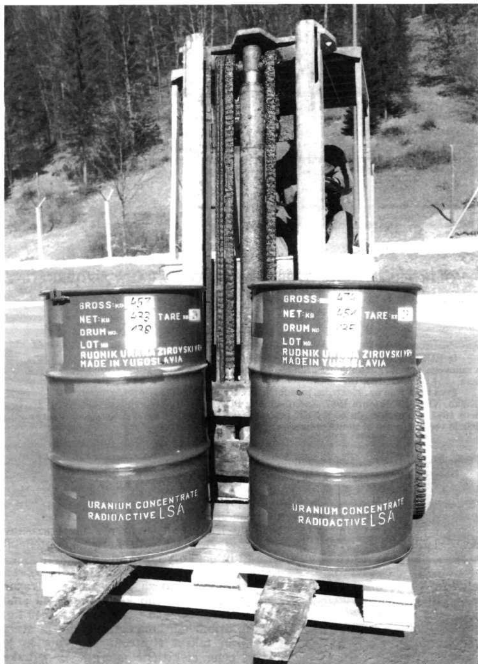
ADU se sme pakirati in prevažati samo v standardnih kovinskih sodih 2101, debeline 1,2 mm. Zapiranje mora biti vodotesno, sodi morajo biti predpisano označeni. Na sliki je prevoz sodov z ADU v skladišče PO RUŽV 28. marca 1986. (Foto Tomaž Lunder)
