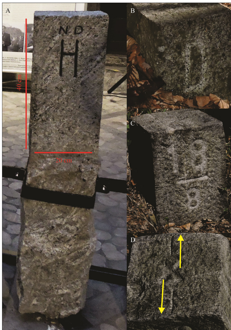
Slika 44: Mejni kamni so izklesani iz enega kosa (magnatske) kamnine. Na stranici, ki je obrnjena proti Nemčiji, imajo vidno črko »D« (B), na stranici, ki je obrnjena proti Hrvaški, pa črke »NDH« (A). Poleg tega imajo tudi dvoštevilčno oznako (na sliki 18–8; C), pri čemer zgornja številka pomeni odsek meje, spodnja pa zaporedje mejnega kamna znotraj odseka. Na zgornji ploskvi imajo tudi dve zarezi, ki kažeta na smer do predhodnega in naslednjega mejnika (D). Na terenu prepoznamo dva tipa mejnih kamnov. Več je »manjših« mejnih kamnov znotraj odsekov, s površino zgornje ploskve približno 20 krat 20 cm. Visoki so približno meter, od tega je nad površjem vidno približno 40 cm (A). Na sliki 45 je znotraj odseka 19 31 »manjših« mejnih kamnov. Vsak odsek se začne z »večjim« mejnim kamnom, s površino zgornje ploskve približno 25 krat 25 cm, ki sega več kot pol metra iz tal.
