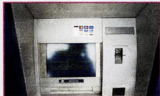
Bankomat z nameščenima obema ploščama oziroma napravo za prikrito branje bančnih kartic (desno pokončno ob monitorju) in napravo za snemanje tipkovnice na bankomatu (vzdolžno nad monitorjem).
