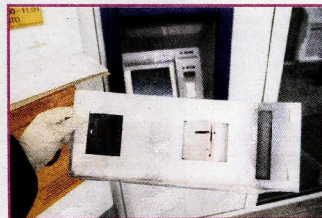
Odstranitev plošče s »skimming« napravo
