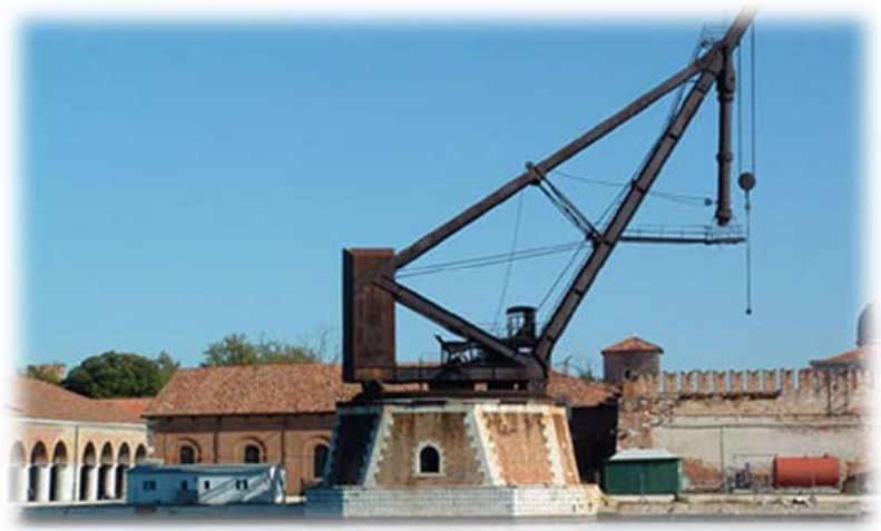
Slika 1 : Pristaniščni hidravlični žerjavi: Armstrongov žerjav (levo) in Armstrong-Mitchellov žerjav (tehnična zapuščina - Arsenal, Benetke) (desno) [2] do [5]
