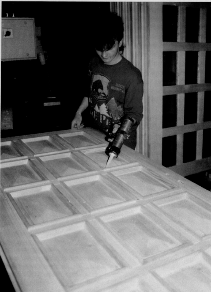
Vstavljanje polnil v masivna vrata V-5
