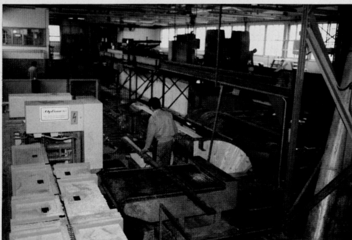
Preurejena žagalnica z novim robilnikom za optimalno robljenje desk
