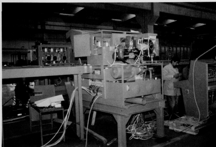
Linije za dolžinsko optimiranje lesa so izdelane v sodelovanju z zahodnonemško firmo Dimter
