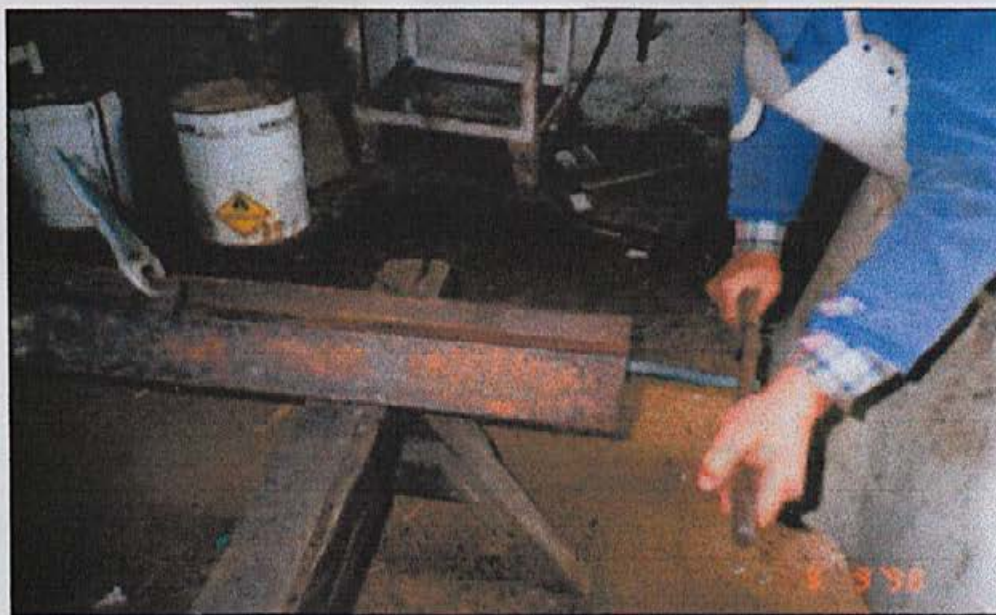
Slika 6. Priprava za zvijanje železne palice
