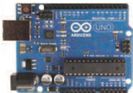
Arduino Uno z Atmelovim mikrokrmilnikom ATMEGA328P
