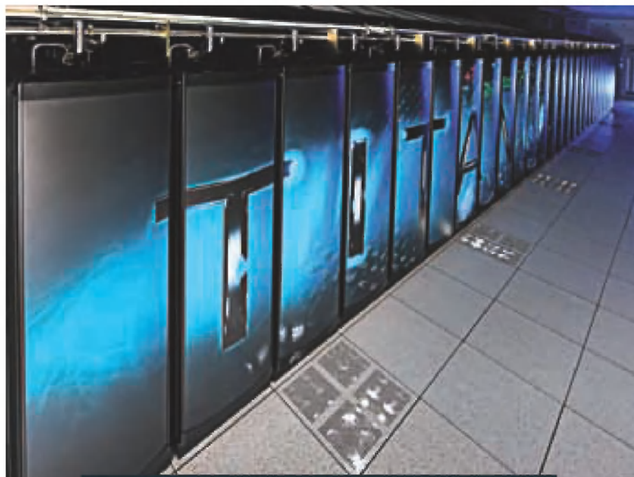
Superračunalnik Cray Titan s teoretično zmogljivostjo 27 petaFLOPS ima 18.688 kartic Nvidia Tesla K20X, ki ima vsaka 2688 jeder.
