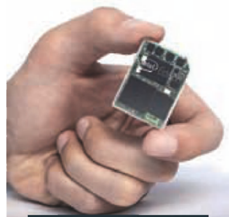
Intel Edison, odprtokodni mikroročunalnik velikosti kartice SD
