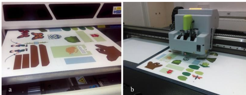
Slika 2: a) Tisk na UV kapljičnem tiskalniku, b) razrez elementov na vodenem rezalniku
