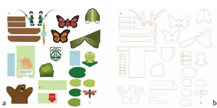
Slika 1: a) Razporeditev premičnih elementov na polo za tisk, b) linije za izrez in pregib
