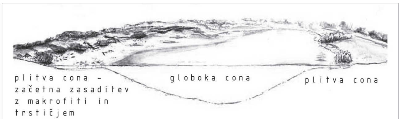
Slika 12: Prerez začetne faze vzpostavitve NH mokrišče (Wasserkraftwerke, 2008)
