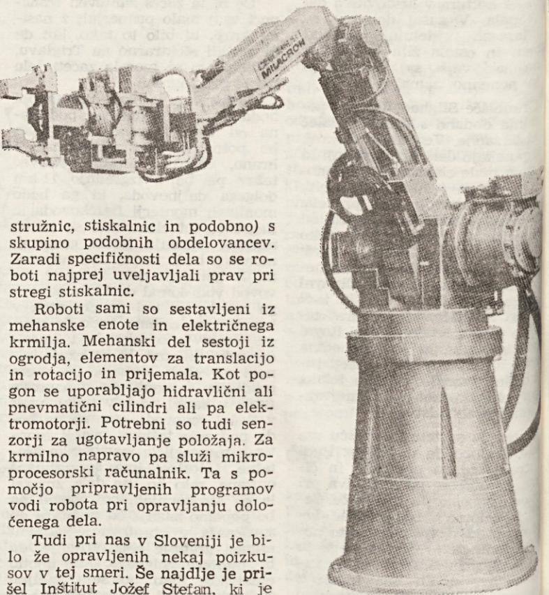
Robot — posluževalna naprava firme Cincinnati Milacron, ki se uporablja pri posluževanju dvigal NC — strojnic
