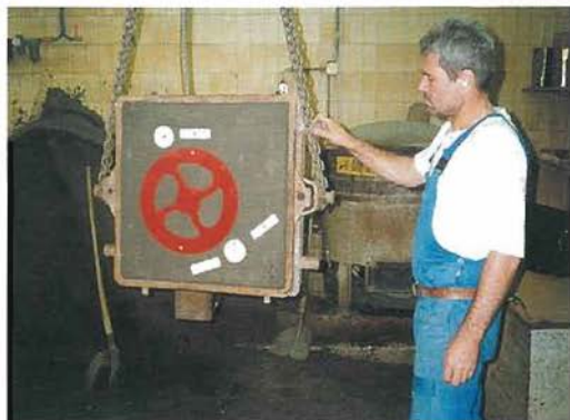
Slika 9: Livarski tehnik Željko Duh je pripravil kalupe za vlivanje koles (foto: Vilman, 2000)
