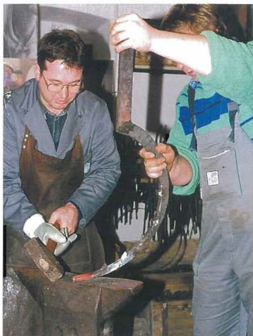
Slika 11: Kovanje konice klešč hlodarskega vozička (foto: Vilman, 2000)
