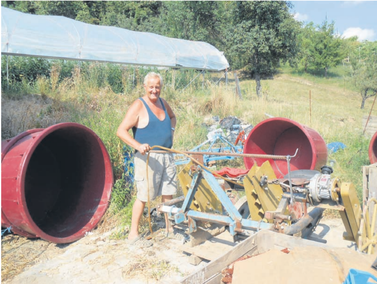
Lastnik Matevževe domačije je ponosno pokazal stroj za sajenje »flanc« oziroma sadik zelja in solate, ki je v veliki meri njegova pogruntavščina. Odlika stroja je preprost sistem, ki bistveno olajša delo. Če je zemlja primerna, lahko dva, ki sedita zadaj, v uri nasadita do 5 tisoč sadik.
