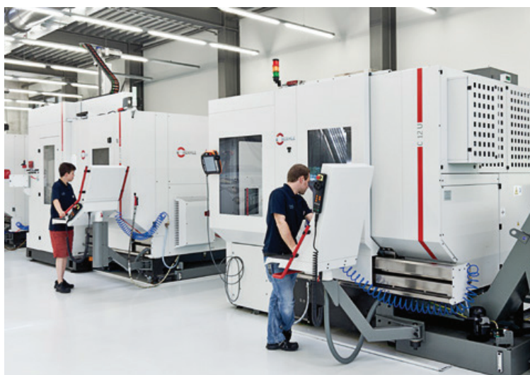
» Levo: delovni prostor petosnega obdelovalnega centra C 22 U z vrtljivo mizo, na kateri je nameščen vpenjalni sistem. Desno: vrsta petosnih obdelovalnih centrov C 22 U s PW 150, C 12 U z RS 05 in C 40 U v novi delavnici podjetja Fetzer Medical GmbH & Co. KG
