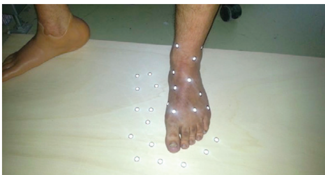
» Proces 3D-skeniranja: na 3D model je najprej potrebno nalepiti odsevne referenčne točke in nato z laserskim bralnikom odčitati obliko predmeta ter jo prenesti v računalniški program za nadaljnjo obdelavo.
