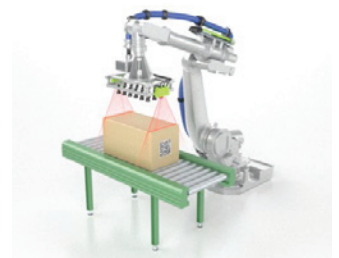
» Natančni merilni laserski sistem za robotsko podprte aplikacije.
