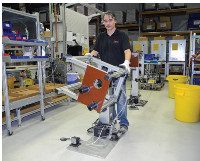
» Zasučni modul je opremljen z indeksserjem, ki ga manualno sproščamo po 45°-korakih (Slika: ROEMHELD)
