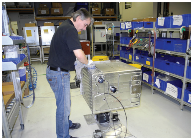
» V predmontaži oblepi sodelavec vseh pet strani z grelno folijo, pri tem mora vsebnik večkrat obračati (Slika: ROEMHELD)
