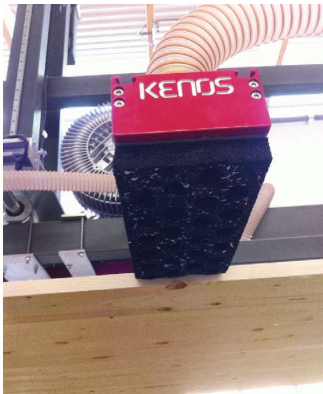
» Slika 1: Vakuumsko prijemalo Kenos®
