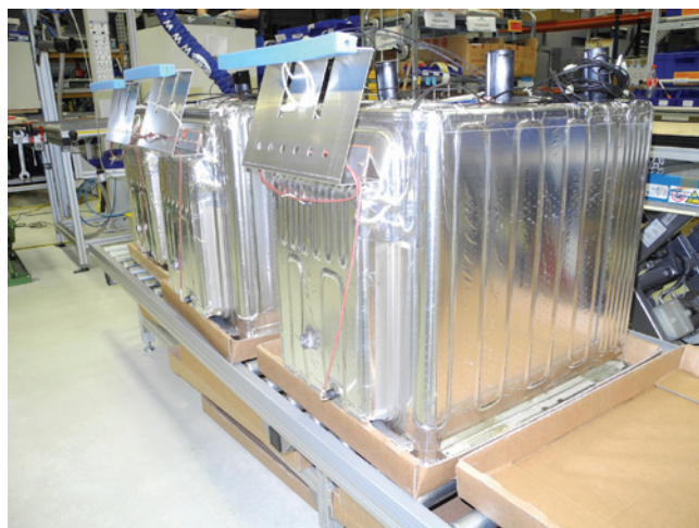
» Po montaži grelnih folij, senzorja in držala čaka notranji vsebnik, da se nanese izolacija in preko vsega montira zunanje ohišje (Slika: ROEMHELD)
