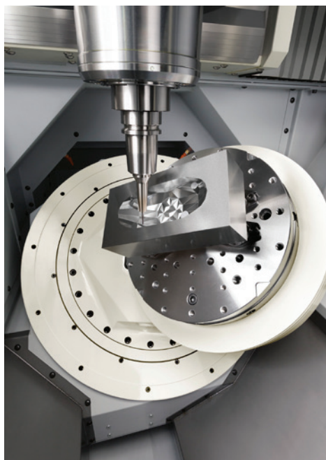
» Slika 2: Toga in dinamična 5-osna miza, podobne zasnovi, kot pri priljubljenem obdelovalnem centru D800Z
