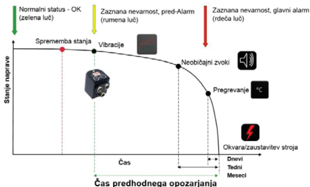
» Slika 2: Prikaz osnovnega spremljanja stanja naprave po načelu semaforja z uporabo zelene, rumene in rdeče luči s pomočjo inteligentnega senzorja vibracij FAG Smart Check
