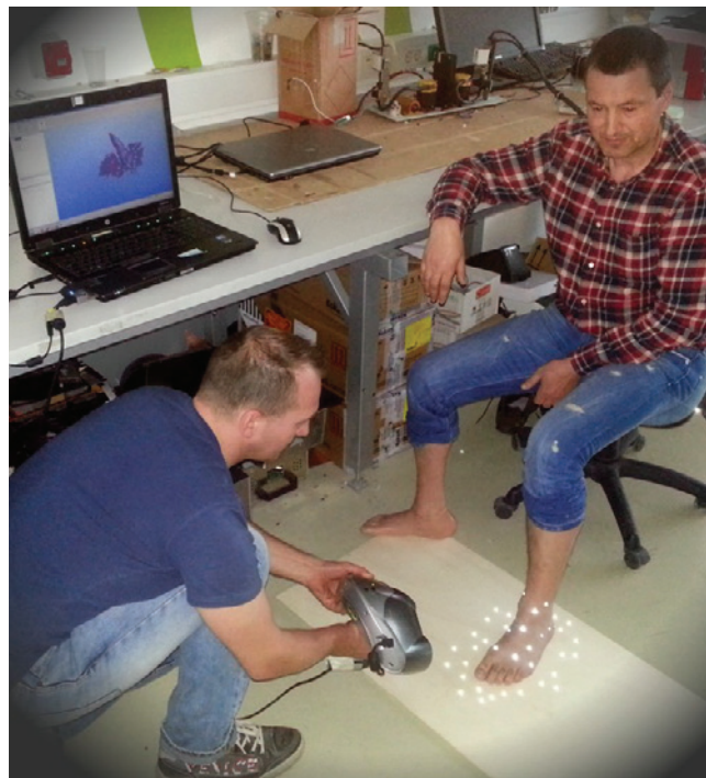
» Proces 3D-skeniranja: na 3D model je najprej potrebno nalepiti odsevne referenčne točke in nato z laserskim bralnikom odčitati obliko predmeta ter jo prenesti v računalniški program za nadaljnjo obdelavo.
