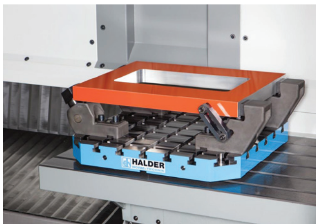
» Slika 2: Z vpenjalnimi podlogami in podložnimi nasloni je na voljo cela miza stroja za vpenjanje obdelovancev
