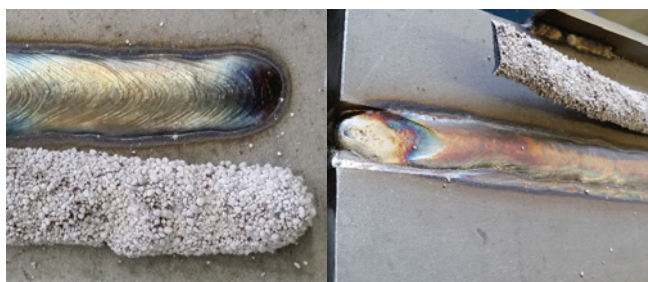
» Slika 2: Preliminarni testi z navarjanjem (levo) in v zv. žlebu na 30 mm pločevini (desno)
