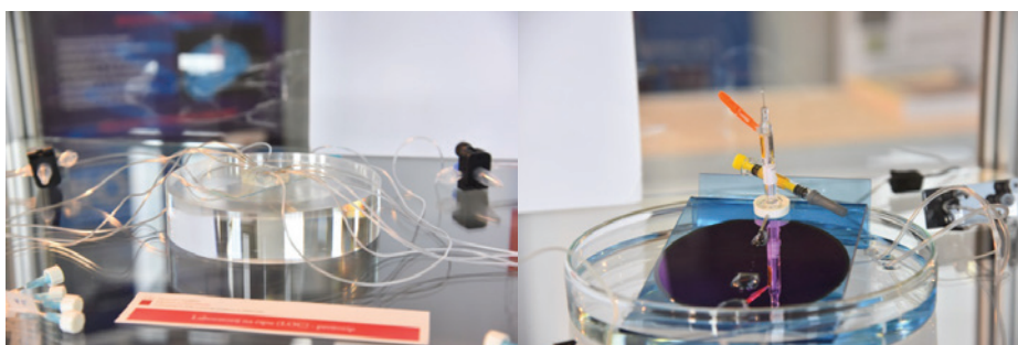
» Laboratorij na čipu in mikrofluidna črpalka (LMSE - Fakulteta za elektrotehniko, Univerza v Ljubljani)
