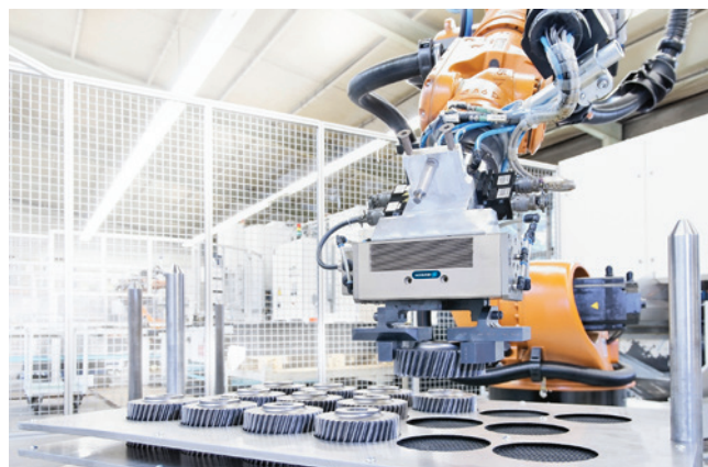
» Mehatronski prijemalni sistem z dolgim gibom, kot je SCHUNK PEH 40, ponuja s spremljivim hodom prijemal veliko prilagodljivost pri manipulaciji različnih izdelkov.
