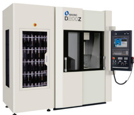
» Slika 3: Obdelovalni center D200Z z zalagovnikom orodij s 100 mesti
