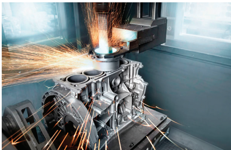
» Tehnologija HELLER CBC za oplaščenje izvrtin cilindrov.
