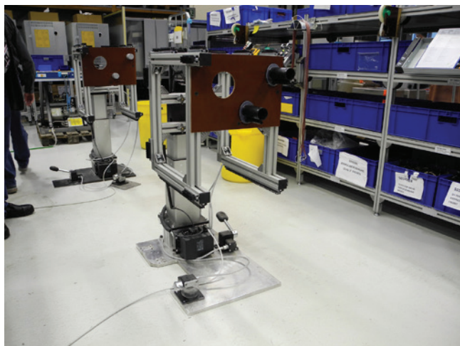
» Vsa delovna mesta so sestavljena iz elektronskega dviznega modula Shop-Floor s hodom 200 mm, ki se dviguje in spušča preko ročnega tipala in zasučnega modula (Slika: ROEMHELD)
