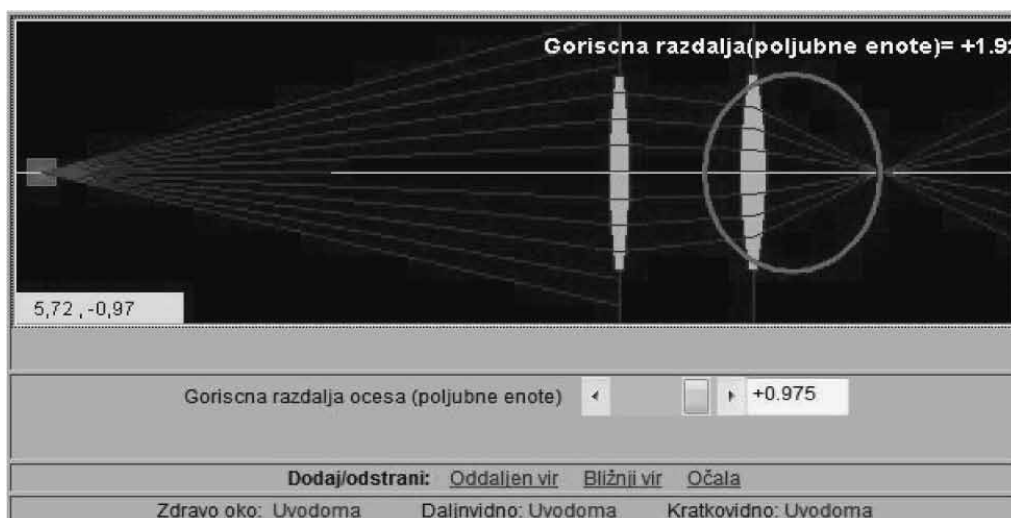
Slika 5: Odprava daljnovidnosti z uporabo zbiralne leče
