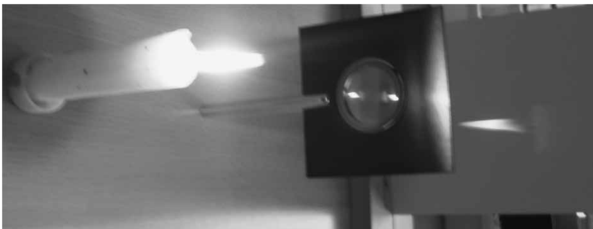
Slika 2: Realna, povečana in obrnjena slika predmeta
