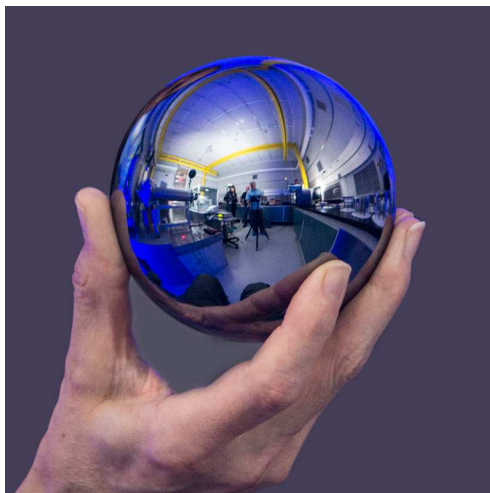
Slika 10. Silicijeva kroglja, s katero določijo enoto za množino snovi mol. Vir: NIST
