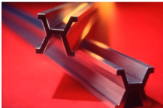
Slika 2. Prameter je izdelan iz posebej trdne in obstojne zlitine 90 % platine in 10 % iridija s posebnim presekom tresca v obliki črke X, ki omogoča torzijsko stabilnost.
