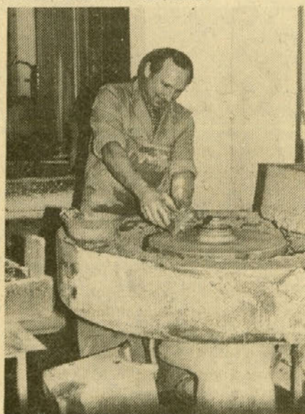
Brusilec v grobi brusilnici Ivan Bračun polira robove vaz – foto Z. Novak
