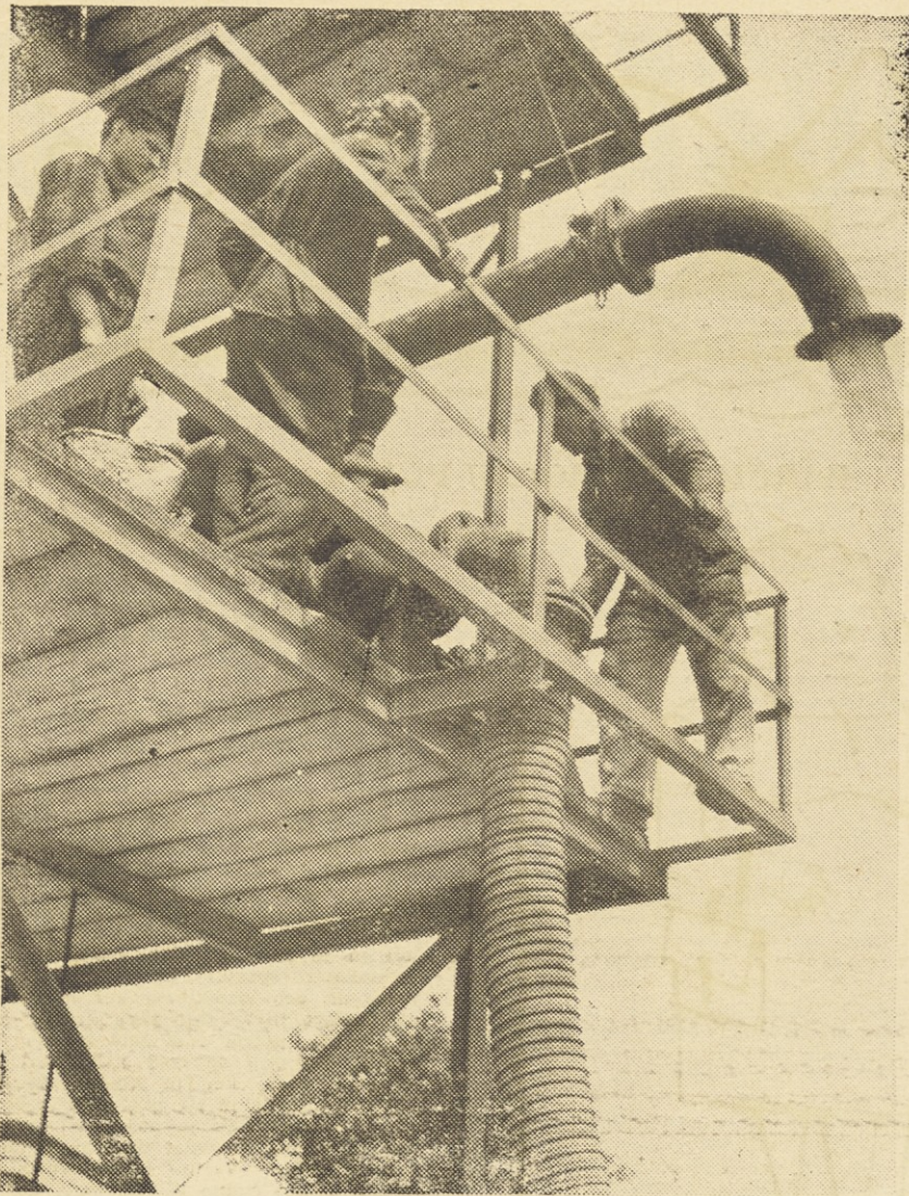
V centralnih obratih so postavili poseben stolp za preizkušnjo vodnih črpavk. Vsaka črpavka mora biti preizkušena, preden jo pošljejo v edinicu
