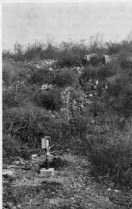
Fig. 5. Piézomètre B—4 équipé d'un limnigraphe depuis 1977, permettant l'enregistrement des marées dans l'aquifère. Profondeur 52,5 m, distance de la côte 4000 m
