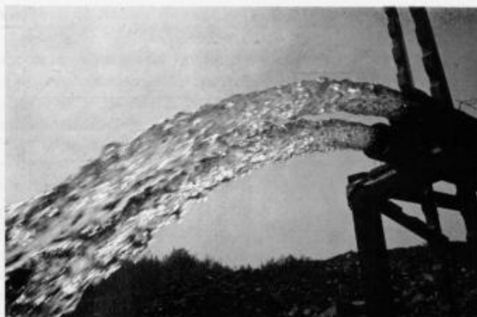
Fig. 4. Pompage d'essai dans le puits VB—4. Débit d'exhaure (103 l/s), rabattement stabilisé 0,44 m. L'eau pompée a été rejetée dans une doline située à 1000 m à l'est du puits
