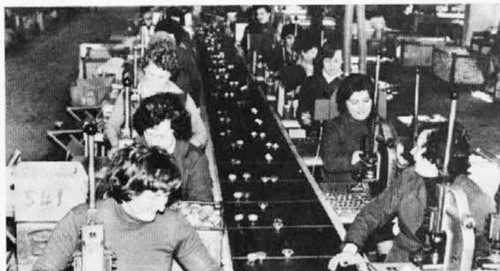
Hitro in natančno delo na tekočem traku — delavke izdelujejo telefonske slušalke
