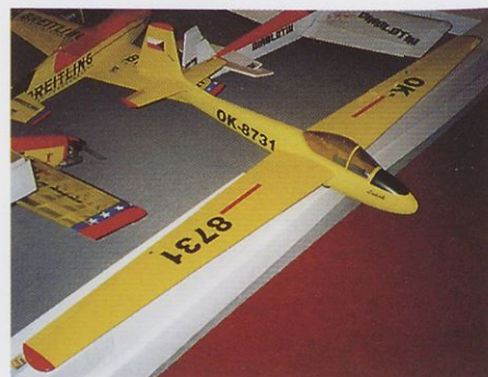
Maketa LF-107 lunak (JR models) z razpnetino 2600 mm tehta 3200 g, ima laminiran trup, stiropropno krilo pa je prekrto s furnirjem.
