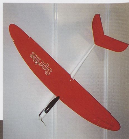
Sprite (1200 mm), izdelek ostravske firme Koado je labko model HLG ali na pogon z elektromotorjem tipa 400.
