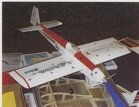
Najmanjša različica diablotina firme JR-models iz Brna je mikro (840 mm, 1–1,5 cm 3 ali speed 400/800).
