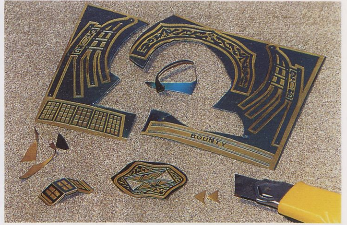
Slika 6. Na izjedkanem kosu medeninaste pločevine, ki ga dobite v kompletu dodatkov, so tri maske za krmni del, sestavni deli bočnih kabin in še dva detajla, ki ju je treba pritrditi na kljuno ladje.
