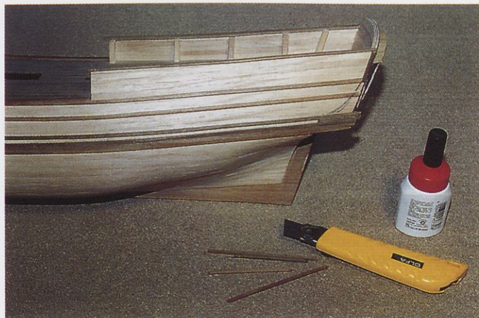
Slika 3. Zgornji rob krmne in ograje je narejen iz koščkov orehove letvice s prerezom 2 \times 6 mm.
