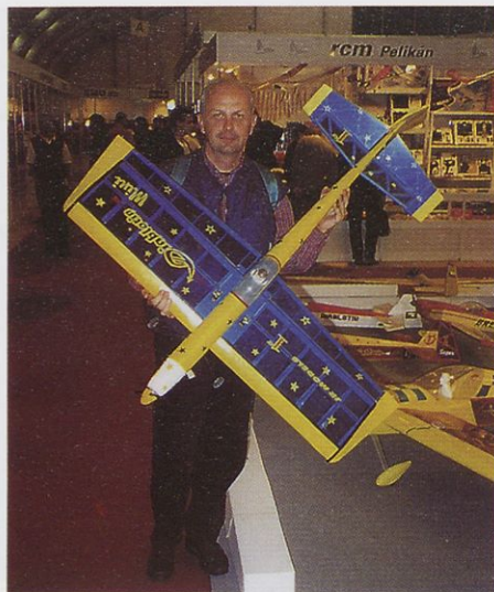
Diablotin mini (JR-models) v rokah Borisa Sekirnika. Model z razpnetino 1280 mm je predviden za pogon z motorji od 3,5–6,5 cm 3 ali ustreznimi elektromotorji.
