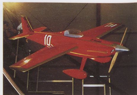
Hackerjev el bandito (1850 mm) po moči motorjev posega v višji razred, saj je kos motorjem od 20 do 80 cm 3 .
