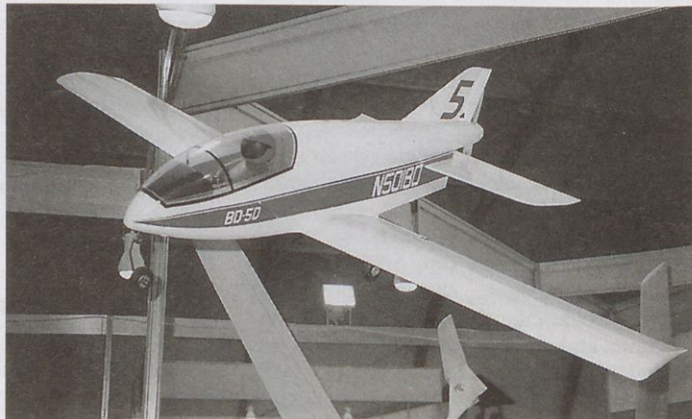
Slika 2. Kljub temu da smo omejeni s številom celic, lahko letimo tudi s tako atraktivnim modelom, kot je tale BD-5D. Polmaketo letala z razpertino krila 1260 mm in maso 1,1 kg poganja motor speed 600, ki se napaja iz 7 celic s kapaciteto 1700 mAh.
