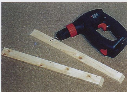
Slika 2. V vse dele pred sestavljanjem izvrtamo 3-milimetrske luknjice, da se les med prodiranjem vijaka vanj ne bo razklat.
