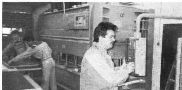
Ferdinand Božičnik vodi stroj za furniranje zaobljenih robov
