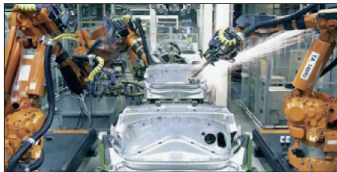
Slika 6. V avtomobilski tovarni Valmet (Finska) je bilo do danes izdelanih preko milijon avtomobilov in od leta 1997 več kot 100.000 tipa Porsche Boxter. Šasija, barvanje in končna montaža so izvedeni s sistemom Omron PLC, povezanim preko komunikacij Ethernet, Controller Link ali Device Net. Poleg tega Valmet uporablja Omronovo senzoriko, frekvenčne pretvornike, RFID in sisteme za vizualno kontrolo.
