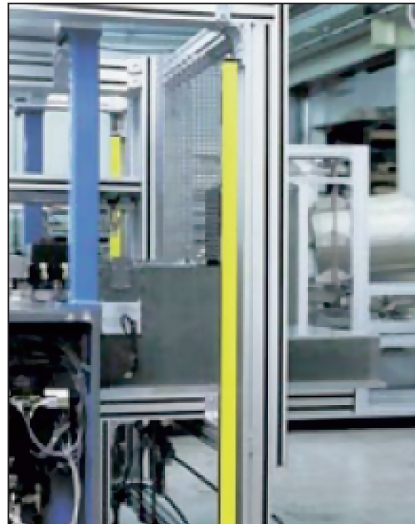
Slika 5. Tovarna Delphi (Francija) proizvede več kot 2 milijona klimatskih naprav letno. Zaradi preproste vgradnje in kompaktnih dimenzij so se odločili za uporabo varnostnih zaves F3SN.
