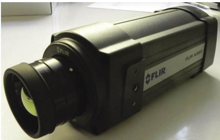
Slika 4 • Termokamera FLIR A320, ki smo jo uporabili pri raziskavah
