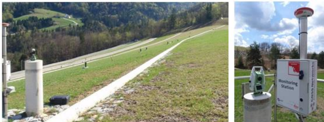
Slika 83: Opazovalna točka II-GPS z nizom kontrolnih točk in opazovalna točka II-GPS ob permanentni GNSS postaji GMX2 (FGG 11/2018) (foto: RŽV)
