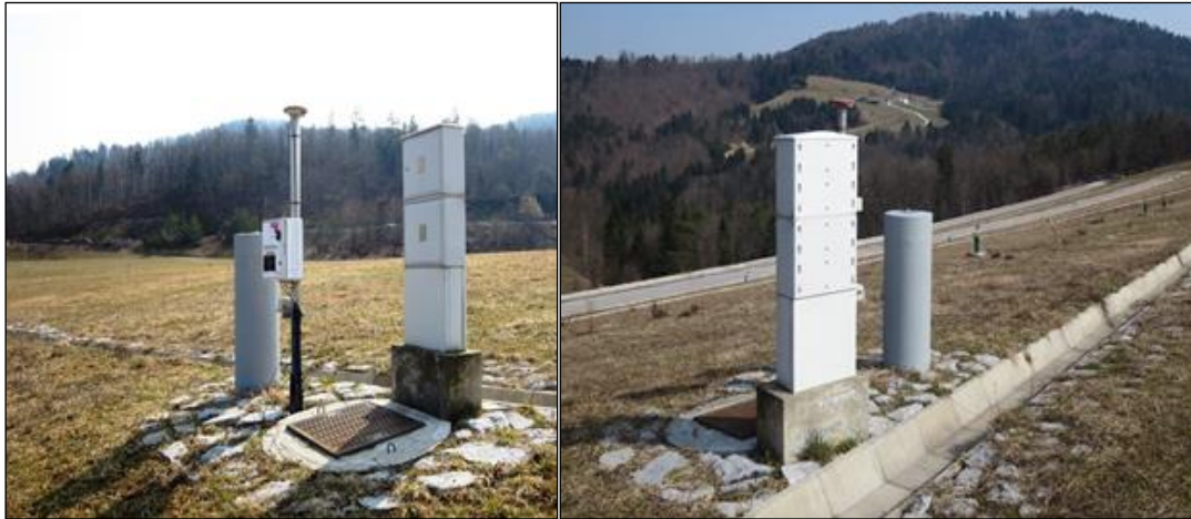
Slika 87: Opazovalna točka GPS nadzora stabilnosti območja odlagališča Boršt II-GPS ob permanentni GNSS postaji GMX2 na zgornji etaži odlagališča
