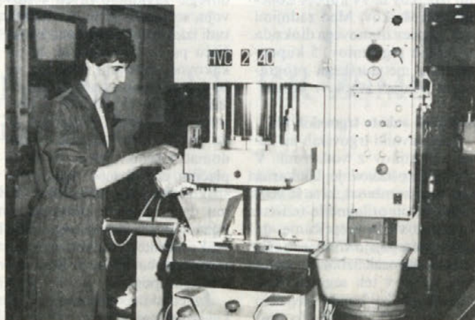
Avtomatsko stiskanje sedežev ventilov iz PTFE materiala
