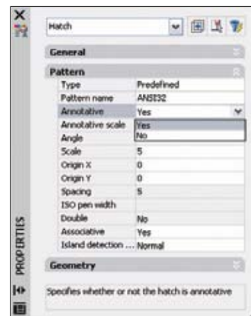
Dodajanje lastnosti Annotative v oknu Properties objektu omogoča, da se samodejno prilagaja merilu.
